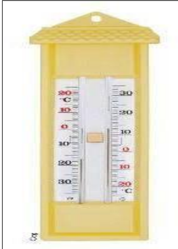
Figura 1: Termômetro de máxima e mínima.
