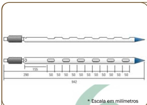
Figuras 4 e 5 : Caladores para amostragem em produtos ensacados e a granel.
