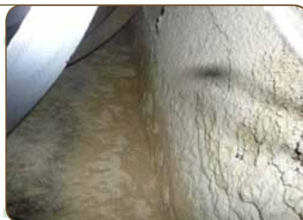
Figuras 27 e 28: Hélices internas do misturador sujas.
