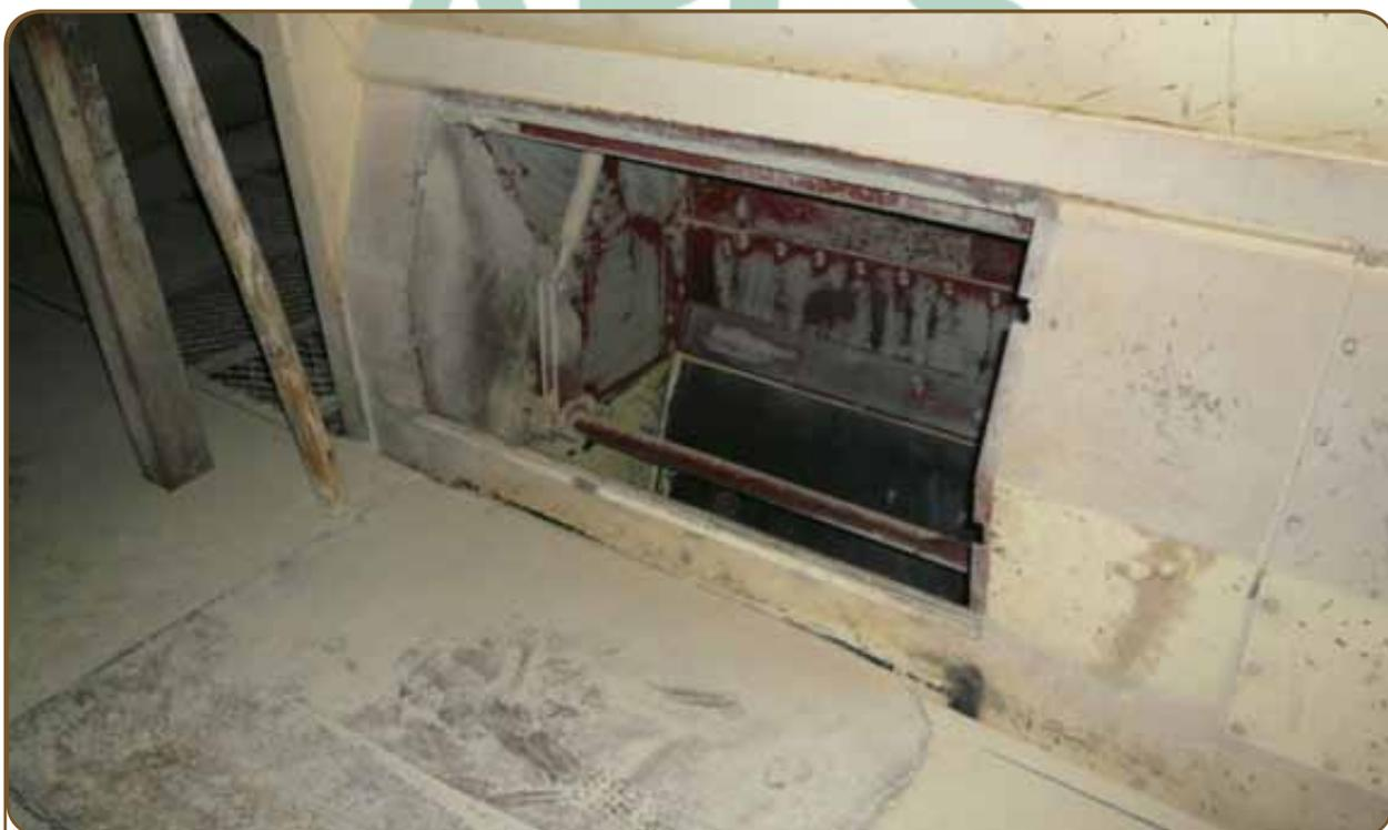
Figura 27: Abertura no misturador para realização de limpeza.
