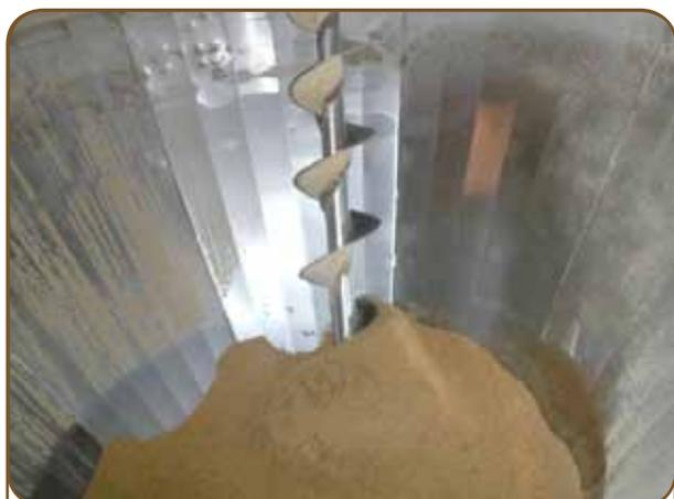
Figura 16: Misturador vertical para silagem grão úmido.
