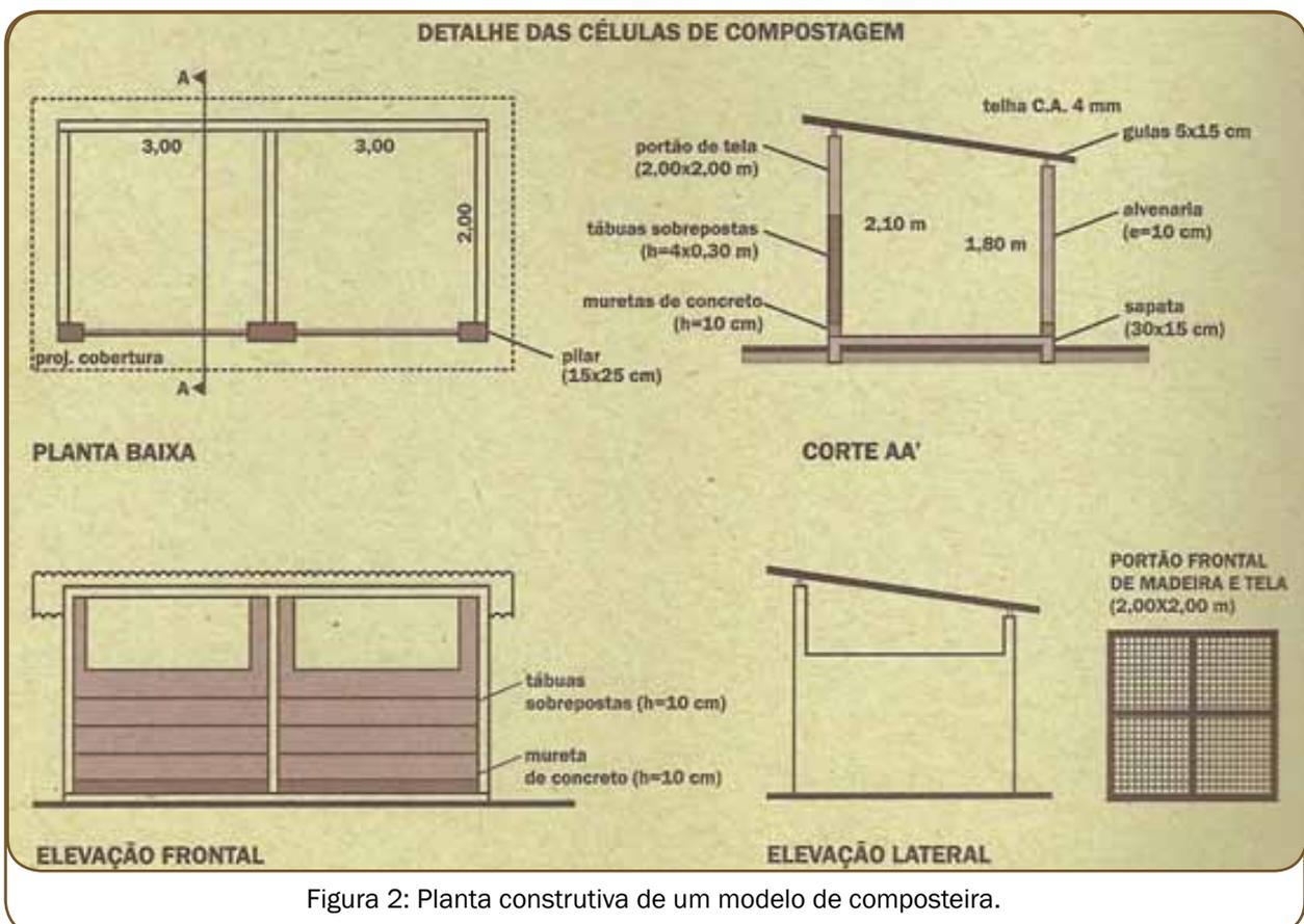
Figura 2: Planta construtiva de um modelo de composteira.
